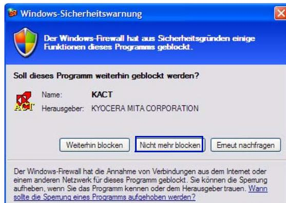
Die Microsoft Windows XP Firewall Einstellungen können so verändert werden, dass Sie die Kommunikation zwischen Computer und Drucker erlauben. Die Grundeinstellung für Windows XP Service Pack 2 ist **An**. Falls der Windows Sicherheits Alarm angezeigt wird, drücken Sie **Freigabe**, um die Kommunikation zu erlauben. Falls Sie **Freigabe** gedrückt haben, trägt sich Auto Konfiguration in die Freigabeliste der Windows Firewall ein. Sie erreichen die Windows Firewall über die Systemsteuerung.
